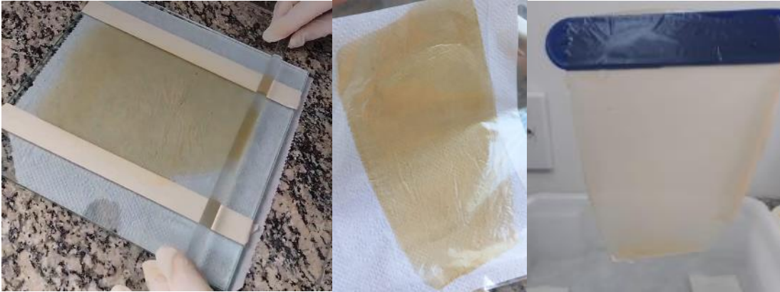
Figura 1- Produção dos filmes de acetato de celulose
