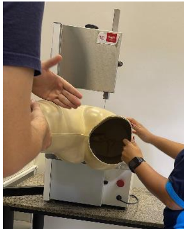
Figura 1 - Processo de corte da perna do manequim
